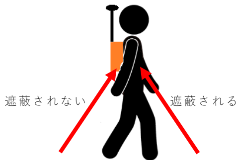
図 11. 方向特性の測定
