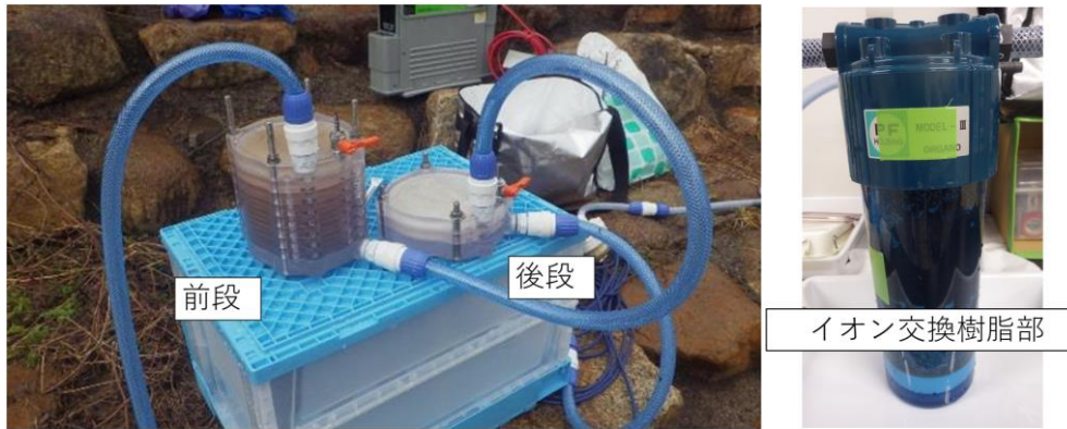
図 3. 放射性セシウム回収装置（多段ろ過装置）
