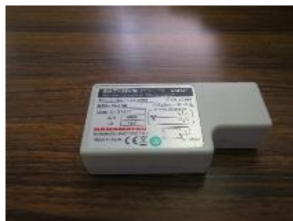
図 17. 高空間線量率用 CsI 検出器 (浜松ホトニクス C12137)
